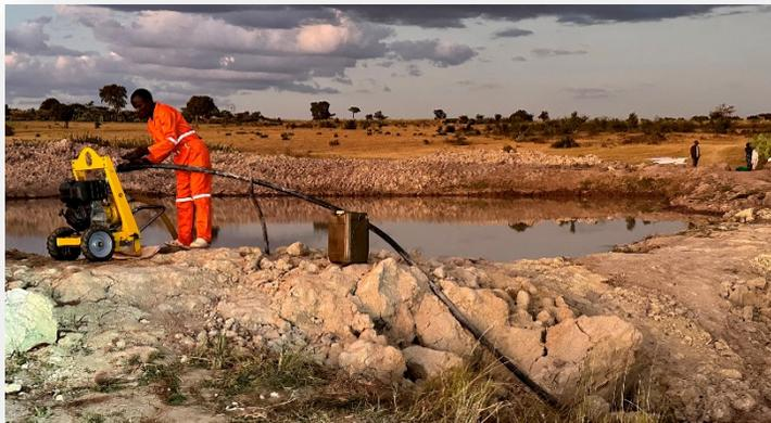
Eine Motorpumpe am Rand des Wasserrückhaltebeckens wird vom Pumpenwart für den Betrieb vorbereitet.
